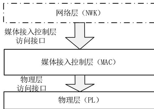
图 4 微功率无线网通信协议架构
