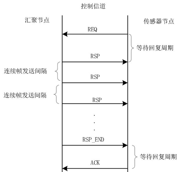
图 8 控制信道配置信息请求与响应过程
