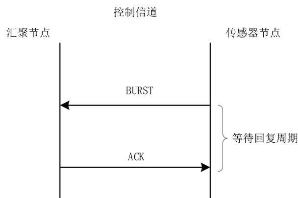
图 12 控制信道突发信息请求和响应过程
